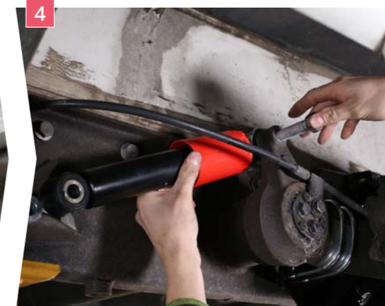
4 Remplacement de l'amortisseur d'origine par l'amortisseur du kit MCK AIR-DRIVE
