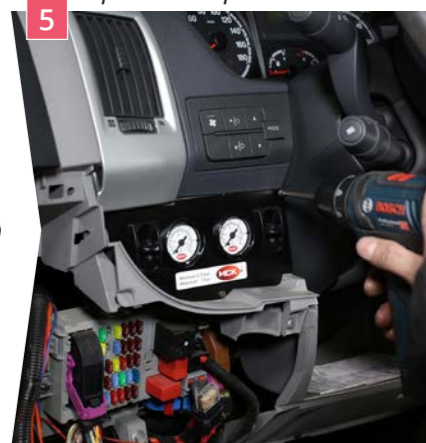
5 Pose du compresseur, du tableau de commande et raccordement électrique et pneumatique
